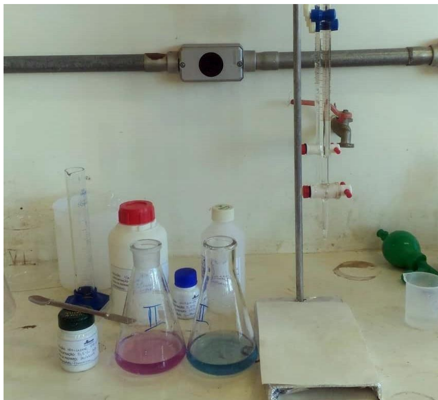
Figura 10: Titulação utilizada para os métodos de Dureza e Cálcio
