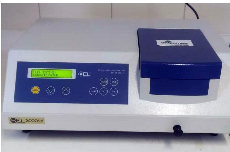
Figura 12: Espectrofotômetro utilizado para análises de Ferro
