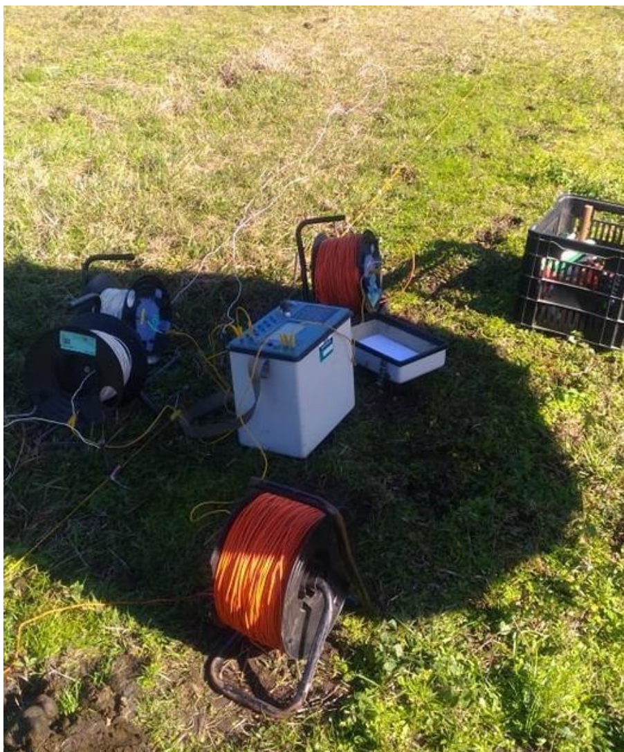
Figura 7: Aplicação do método da SEV através do resistivímetro
