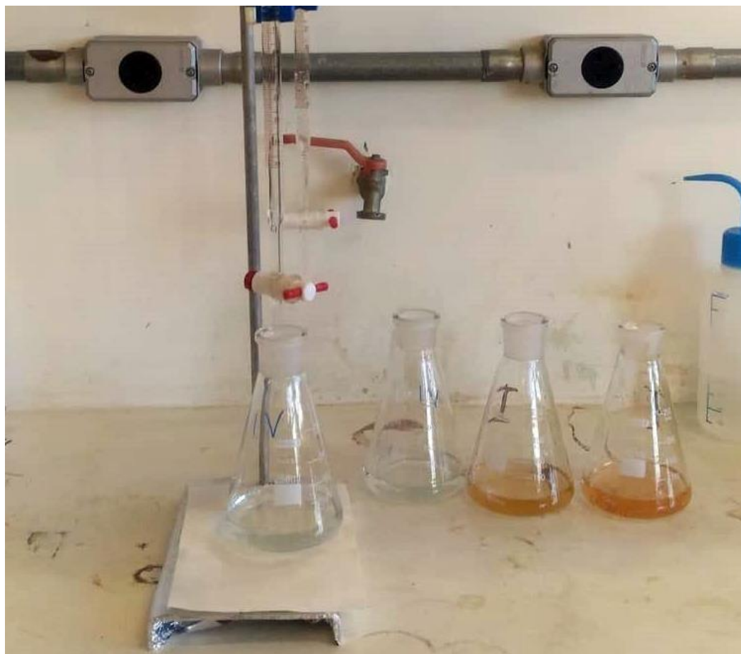
Figura 13: Titulação para determinação de cloretos
