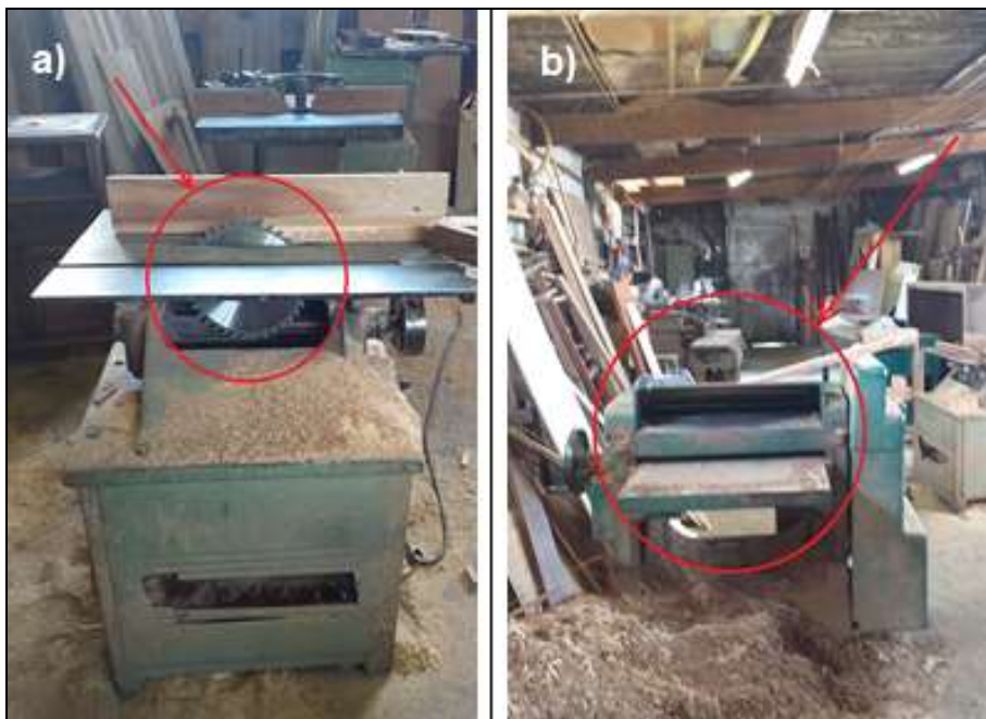
Figura 14 – Máquinas: a) serra circular e b) desengrossadeira
