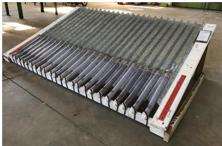
Figura 8 - Mesa de checagem para análise da distribuição volumétrica das pontas, confeccionada com base na norma ASTM E641-01.
