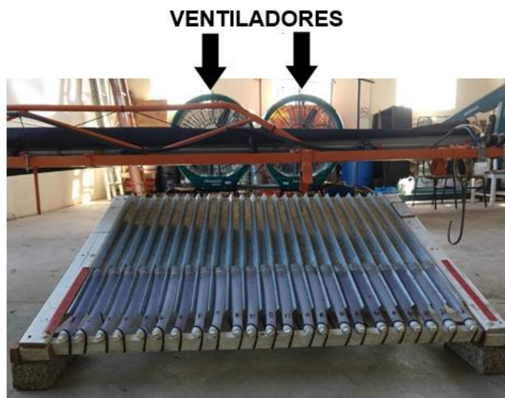
Figura 9 - Esquema da posição da mesa de checagem, dos ventiladores e da barra de pulverização
