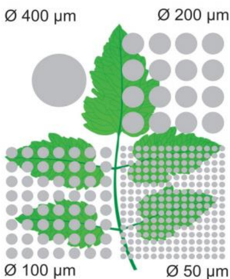
Figura 1 - Representação da cobertura oferecida pela pulverização com diferentes tamanhos de gota.
