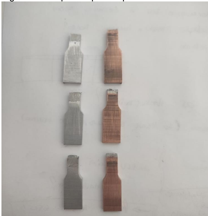
Figura 7 – Corpos de prova após ensaio de dobramento.
