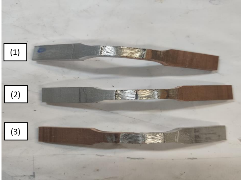
Figura 11 – Corpos de prova após ensaio de dobramento.
