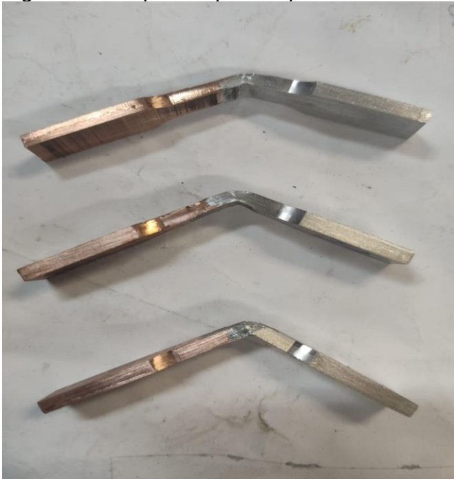
Figura 9 – Corpos de prova após ensaio de dobramento.
