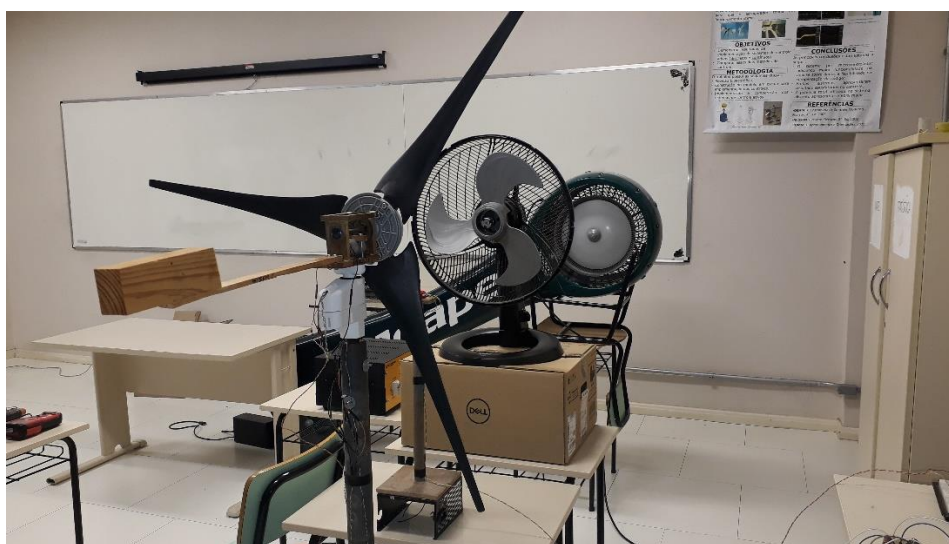
Figura 60. Corredor de vento criado com os dois ventiladores em série.
