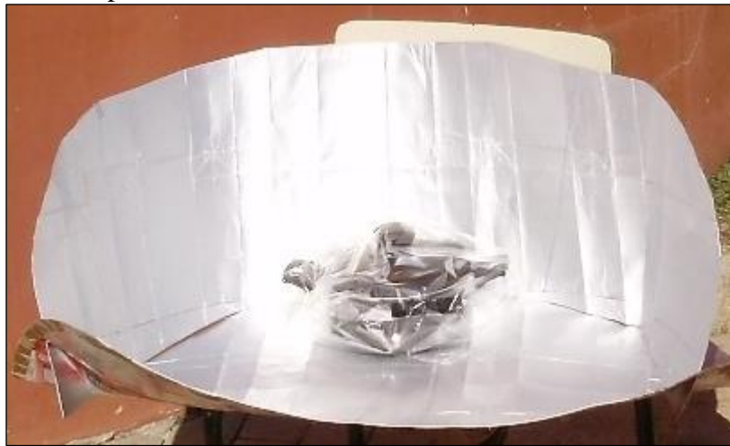
Figura 30 – Modelo do painel em Tetra Pak.
