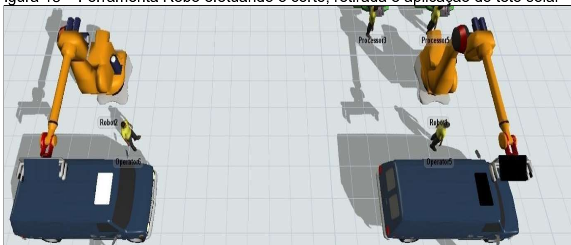
Figura 18 – Ferramenta Robô efetuando o corte, retirada e aplicação do teto solar
