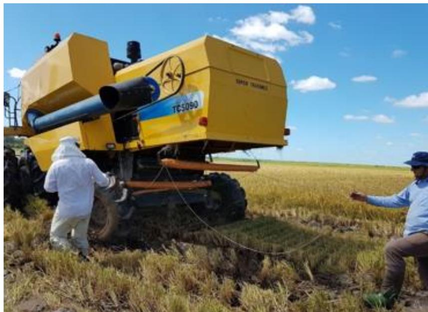
Figura 6. Coleta das perdas dos mecanismos no momento da colheita.
