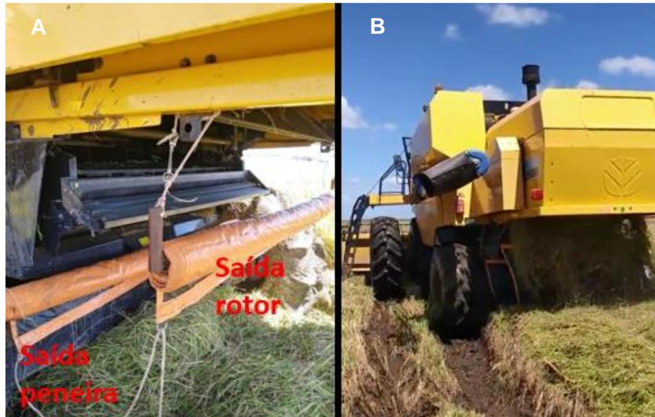
Figura 5. Lonas instaladas nos mecanismos (A), Coleta das perdas nas lonas (B).
