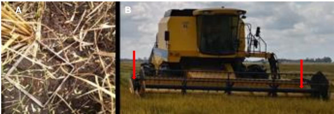
Figura 4. Aferição das perdas com gradil (A) e Máquina durante a colheita (B).
