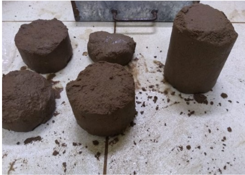
Figura 31- Resultado da imersão dos CP's do tratamento S-FS-CH: 85%-10%-5%. Fonte: Autor
