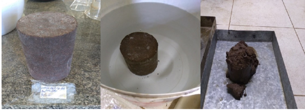
Figura 19 - Teste de imersão por período de 4 horas do tratamento S-M: 75%-25% Fonte: Autor
