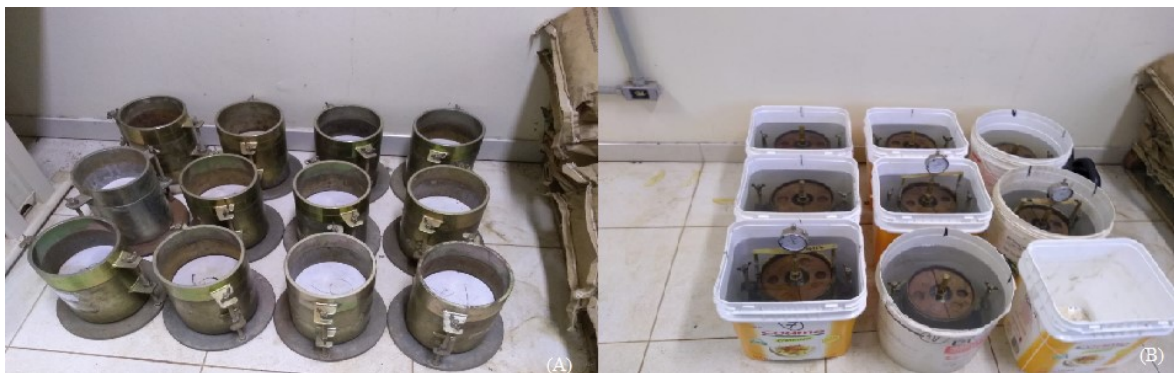
Figura 24 - (A) Corpos de prova para o ensaio ISC em cura. (B) Ensaio de expansão Fonte: Autor
