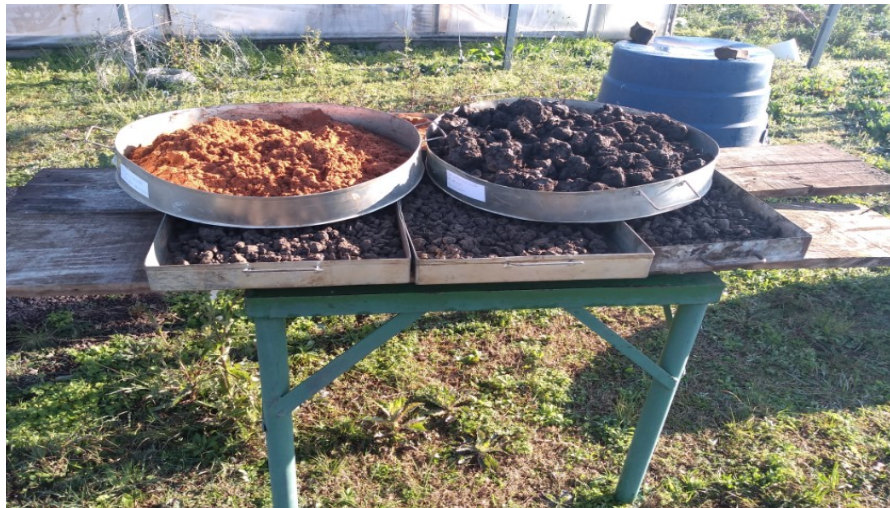
Figura 11 - Processo de secagem ao ar, das amostras coletadas. Fonte: Autor
