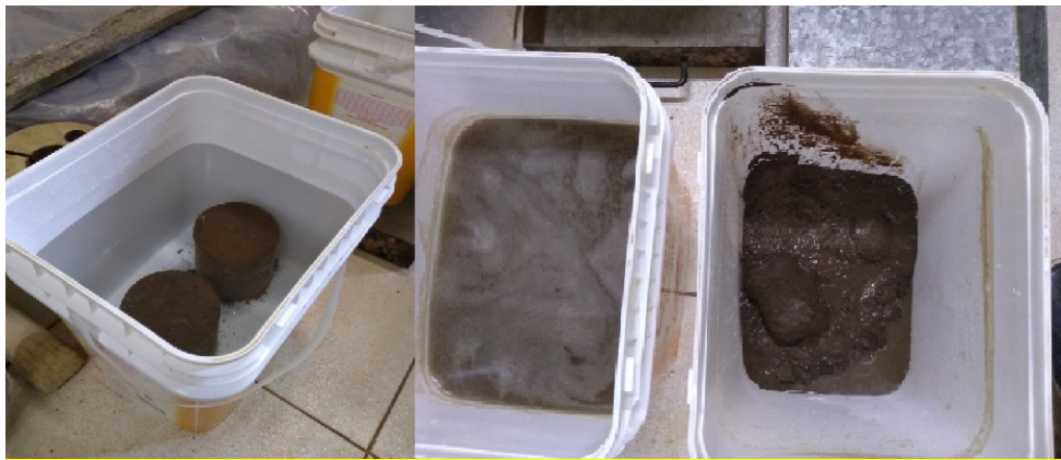
Figura 20 - Teste de imersão por período de 4 horas dos tratamentos S-M: 80%-20% e S-M: 85%-15%. Fonte: Autor
