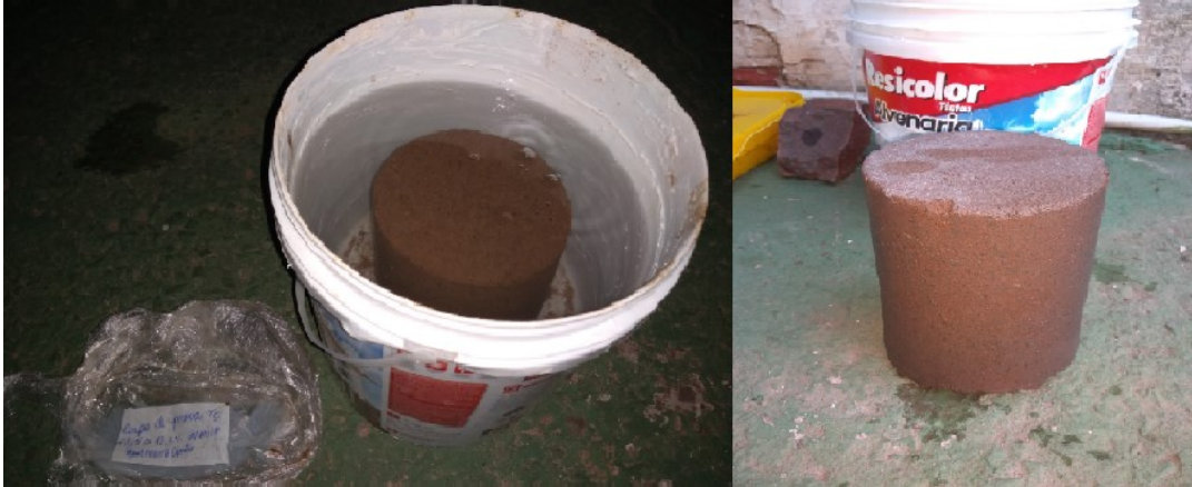
Figura 22 - Teste de imersão por período de 4 horas do tratamento S-M-CH: 80%-15%-5% Fonte: Autor
