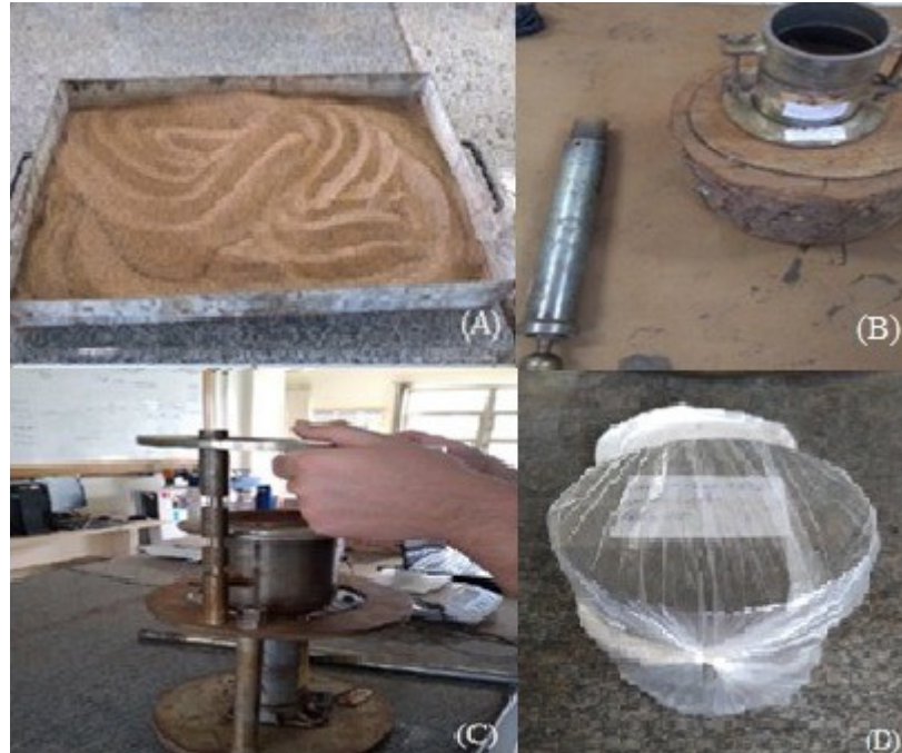
Figura 16 - (A) Preparação das misturas; (B) Soquete e cilindro; (C) Extrator; (D) Amostra acondicionada em papel filme e saco plástico.
