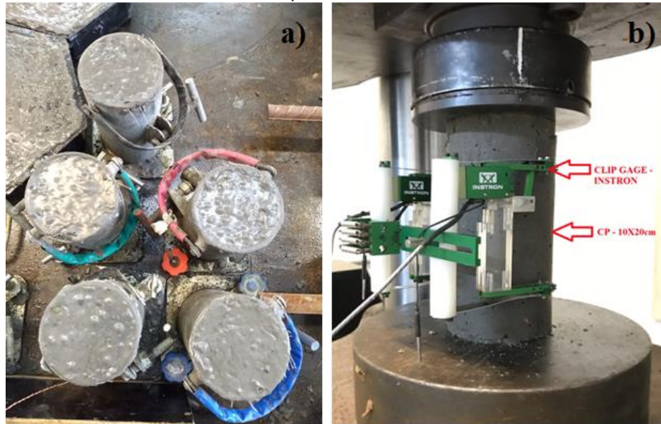
Figura 35 – Corpos de prova cilíndrico. a) Produção das amostras. b) instrumentação para ensaio de compressão axial.
