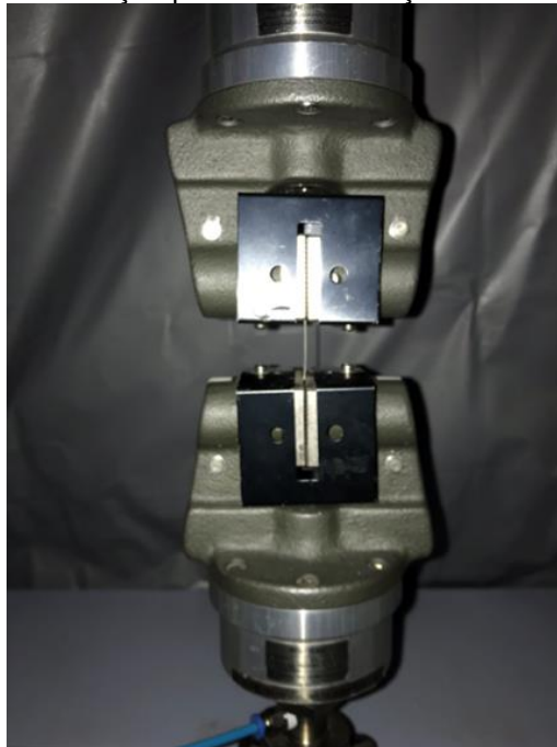
Figura 25 – Ensaio de tração pura na fibra de aço – DRAMIX 3D 65/35 BG.
