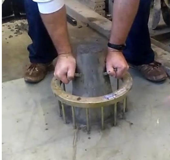
Figura 33 – Ensaio de “habilidade passante” por Anel “J”.
