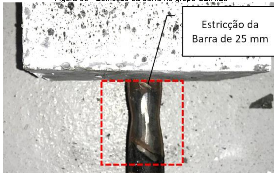
Figura 66 - Estricção da barra no grupo C2.H.25
