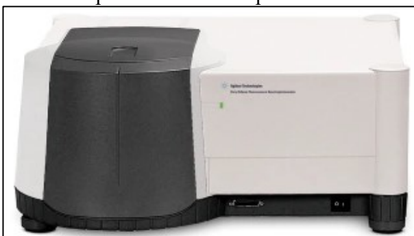
Figura 3.4 - Espectrômetro utilizado para realizar os experimentos de fotoluminescência.
