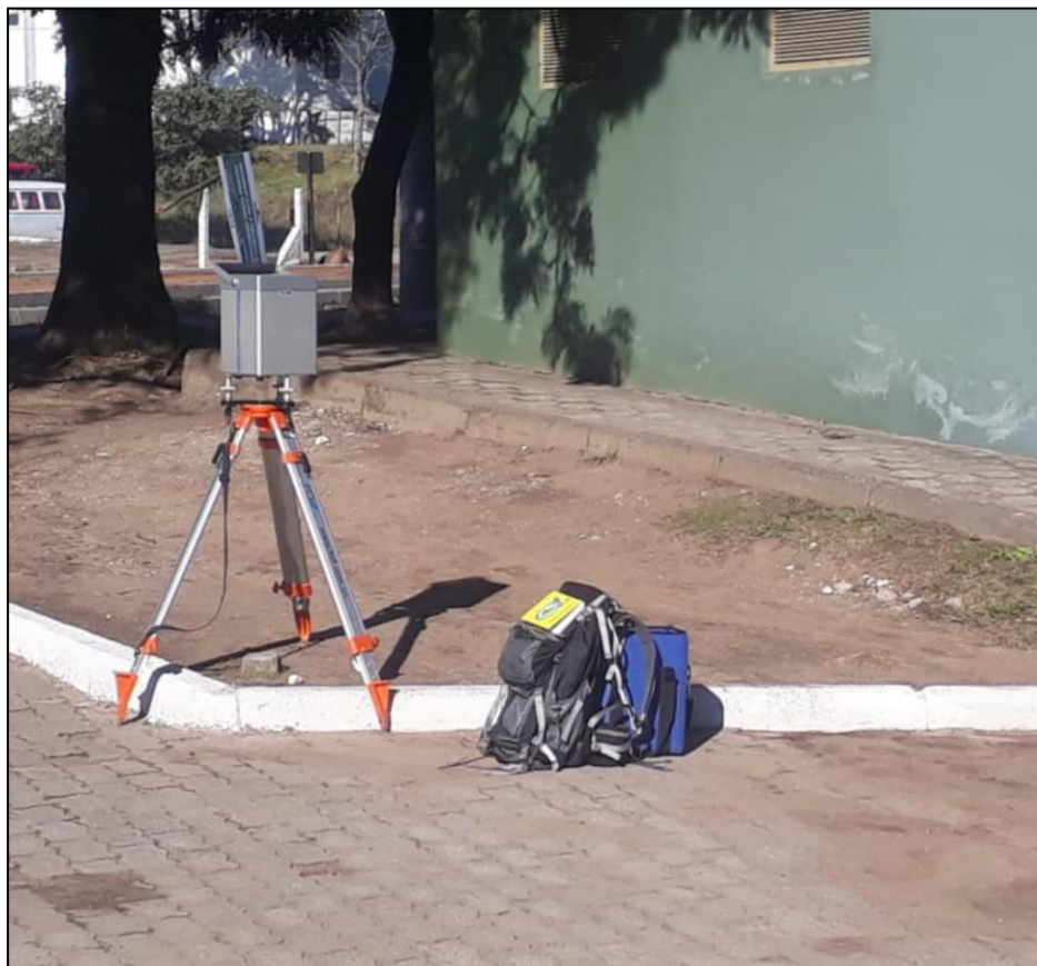
Figura 13. Medidas com o gravímetro na Estação Gravimétrica Base - Campus Unipampa Caçapava do Sul.
