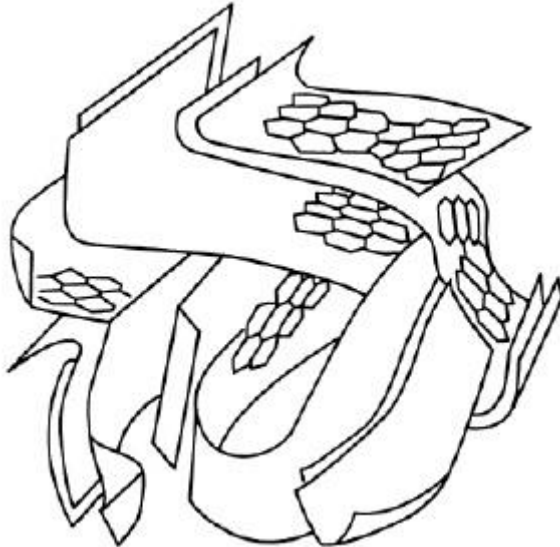
Figura 3.10 - Estrutura porosa de um carvão ativado
