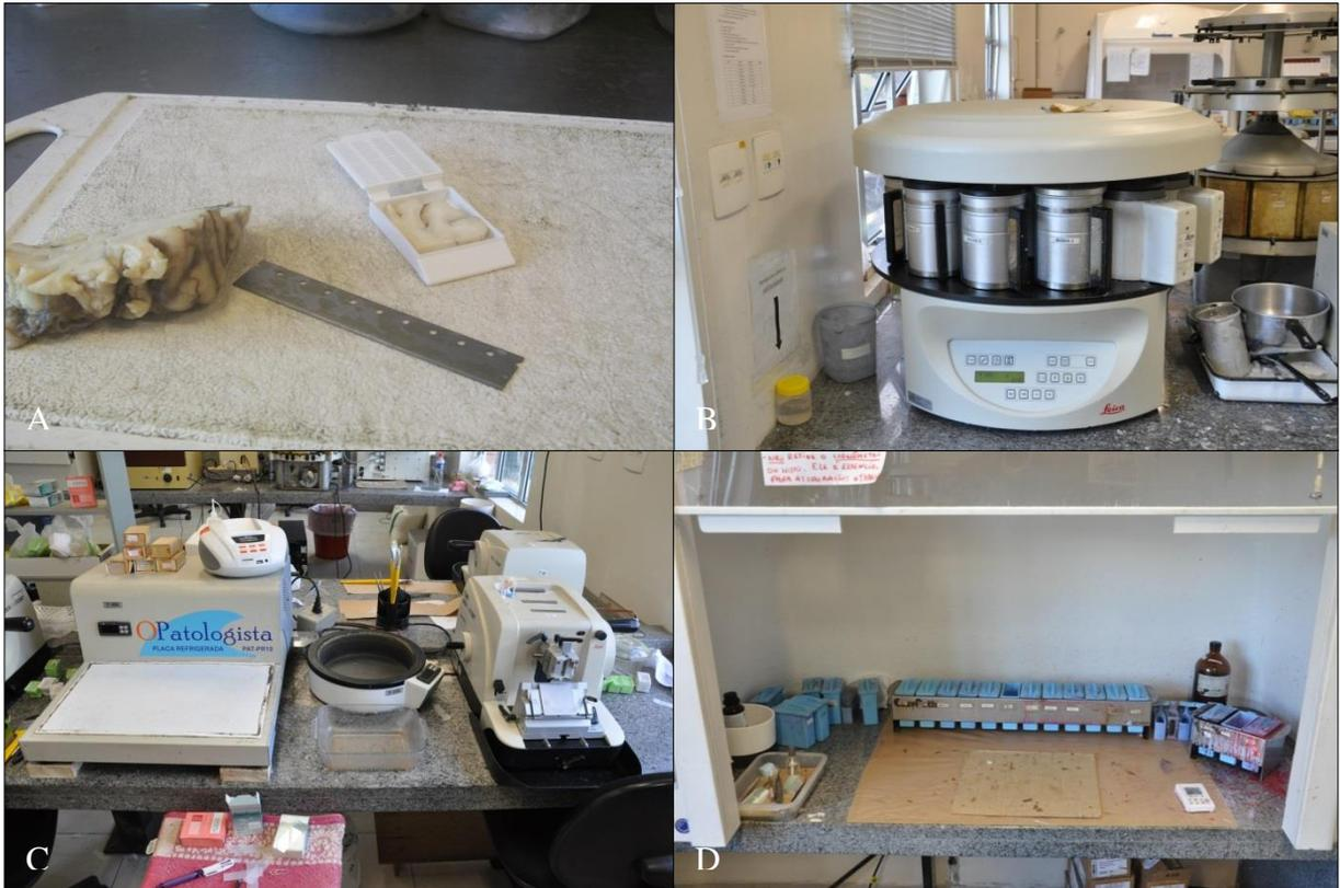
FIGURA 3 – A. Fragmento de encéfalo clivado e encaminhado em cassete para posterior processamento em bloco de parafina. B. Aparelho responsável por processar em blocos de parafina (Histotécnico). C. Aparelhos utilizados para realização dos cortes histológicos. D. Bateria de coloração de hematoxilina e eosina. Fonte: o autor.
