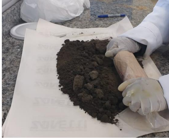
Figura 12 - Destorroamento manual do solo com cilindro de madeira.
