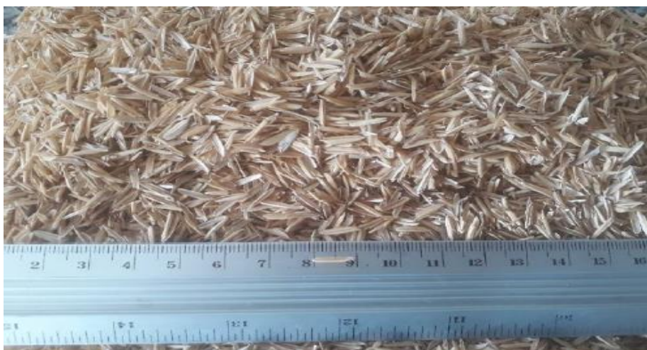
Figura 1 - Casca de Arroz utilizada para os diversos testes e produção dos vidros.
