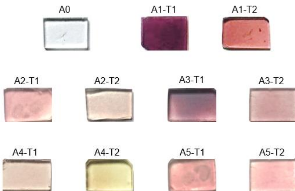
Figura 21 – Imagem dos vidros produzidos utilizando CCA, com e sem tratamento químico bem como o vidro fabricado utilizando areia como fonte de sílica
