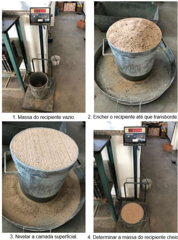
Figura 25 - Determinação da Massa Unitária - Método C
