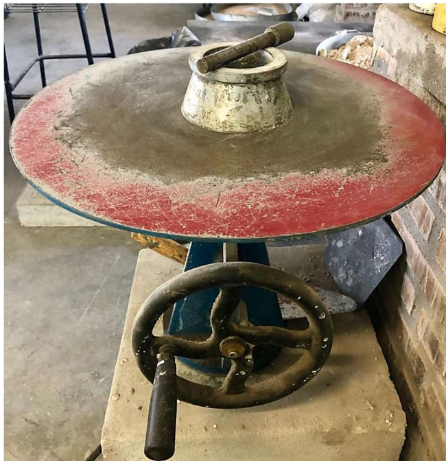
Figura 36- Equipamento utilizado para a determinação do índice de consistência
