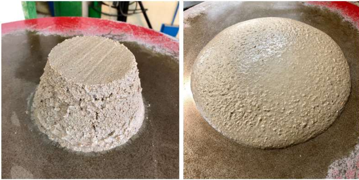
Figura 52 - Traço T0PV no Ensaio de Índice de Consistência
