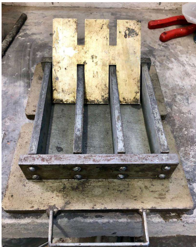
Figura 31 – Moldes prismáticos utilizados na moldagem das argamassas
