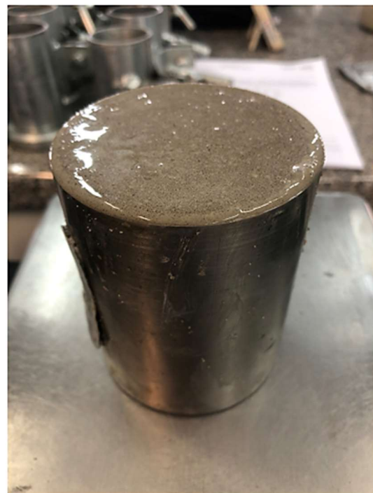
(b) Molde com argamassa ao fim do ensaio.
