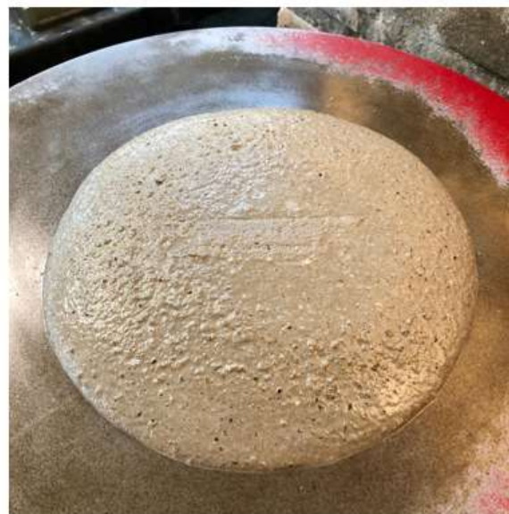
Figura 54 - Traço T10PV no Ensaio de Índice de Consistência
