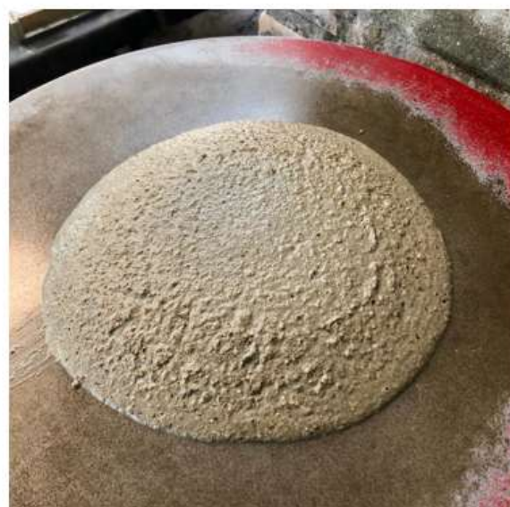
Figura 55 - Traço T15PV no Ensaio de Índice de Consistência
