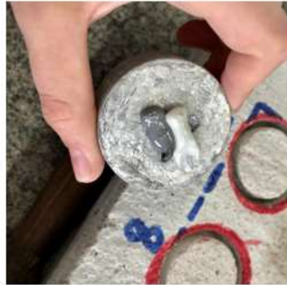
2. Aplicação dos componentes da cola POXIPOL na pastilha metálica.
