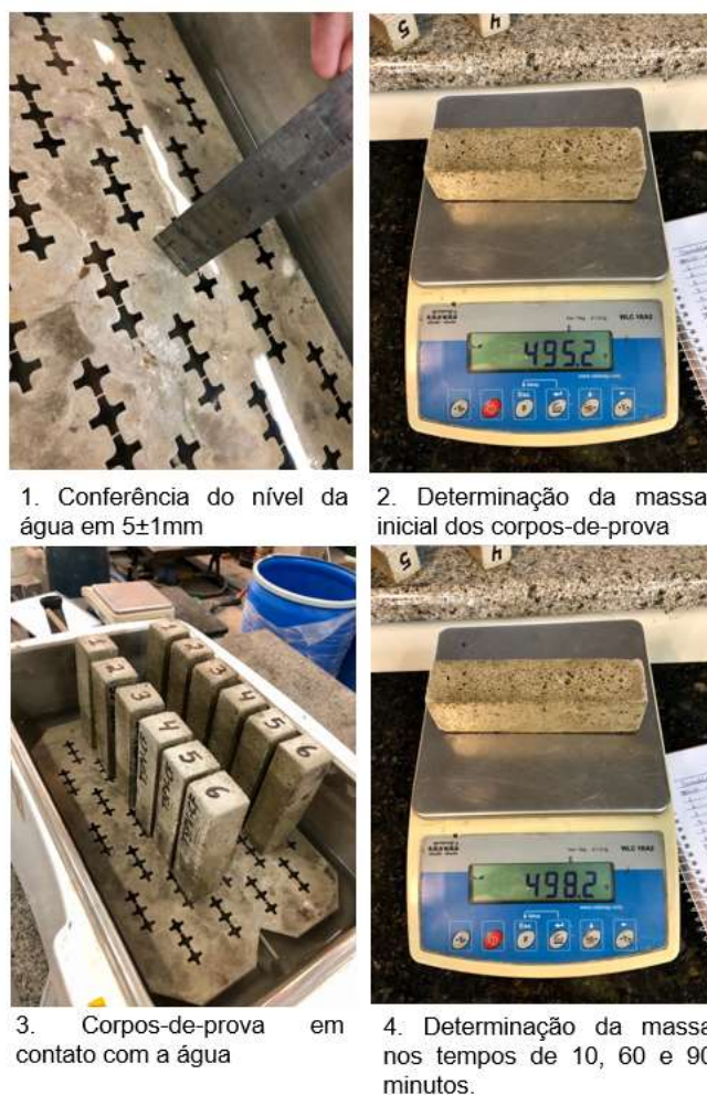
Figura 42 - Procedimento do ensaio de absorção de água por capilaridade
