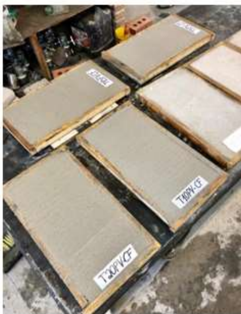
4. Imprimação dos traços de argamassa.
