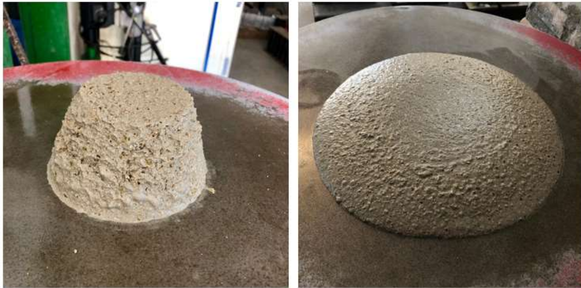
1. Antes da aplicação dos golpes na mesa de consistência.
