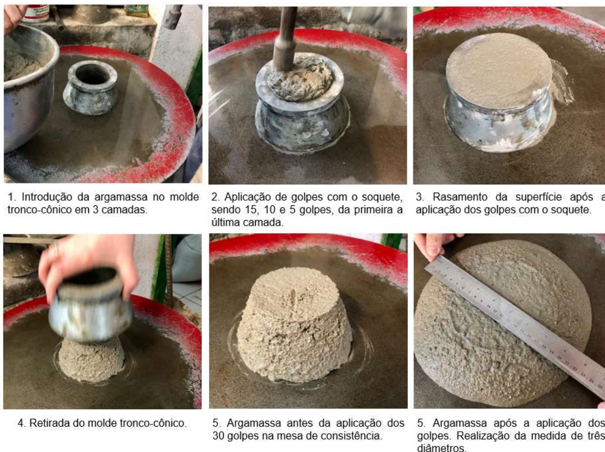
Figura 37 - Procedimento do Ensaio de Índice de Consistência
