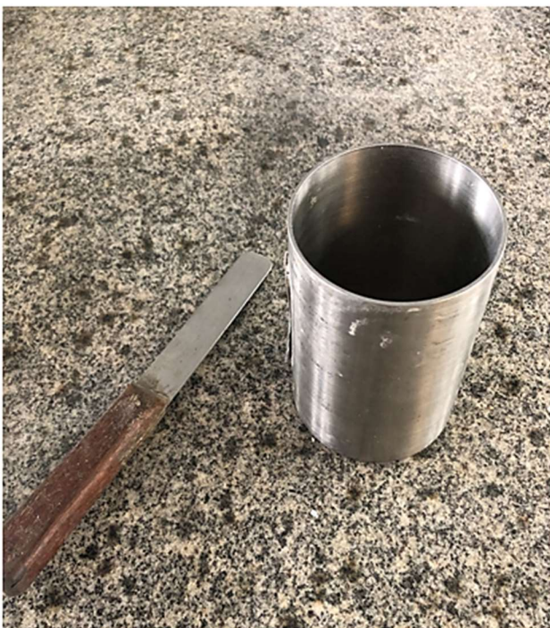
(a) Espátula e recipiente rígido utilizados no ensaio.
