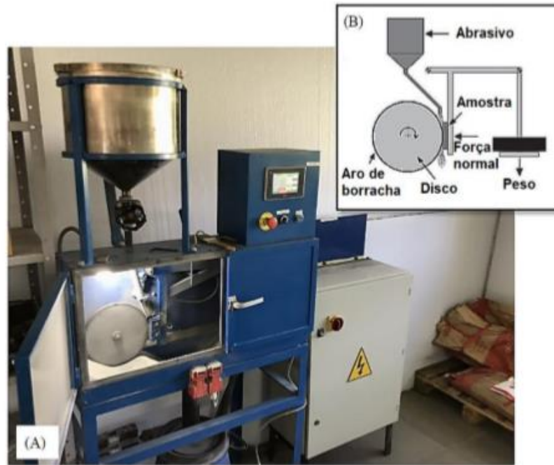
Figura 19 - Equipamento utilizado para ensaio de desgaste. Empresa Rijeza. (A) Foto equipamento (B) ASTM G65-16.
