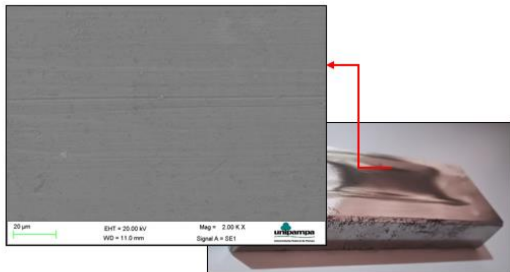
Figura 28 – Superfície desgastada do aço VPATLAS - MEV.
