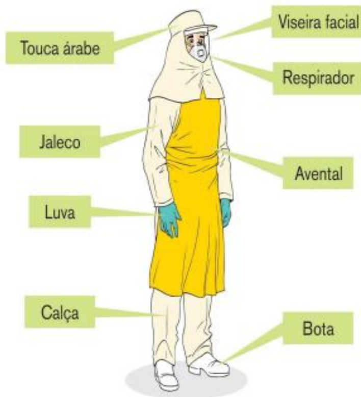
Figura 3 – Equipamento de proteção individual (EPI) necessários para à segurança do trabalhador rural.
