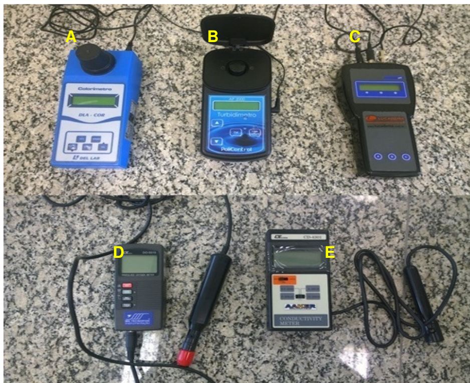
Figura 22 - Equipamentos eletrônicos utilizados para as análises (A) colorímetro, (B) turbidímetro, (C) pHmetro, (D) Oxímetro e (E) condutivímetro.
