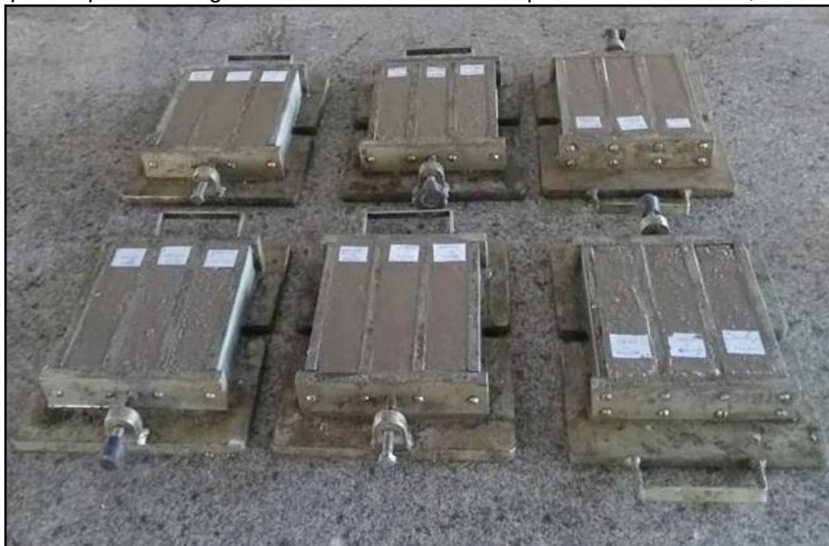
Figura 31 – Corpos de prova da argamassa contendo 3% de LC para as idades de 28,56 e 91 dias
