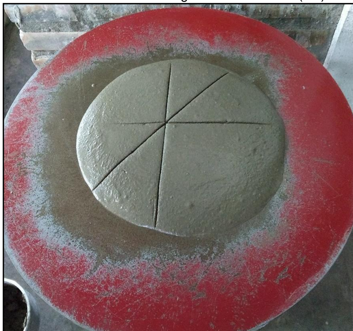
Figura 32 – Ensaio do índice de consistência da argamassa referênciada (AR)
