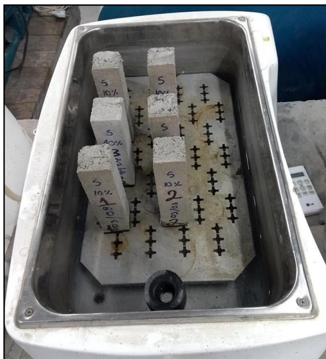
Figura 33 – Ensaio de absorção de água por capilaridade
