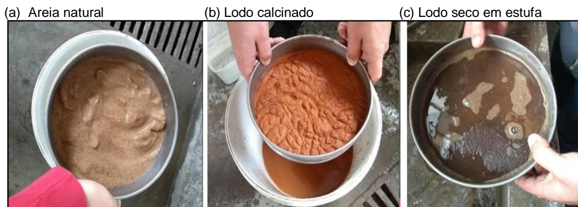
Figura 28– Ensaio de material pulverulento dos materiais
