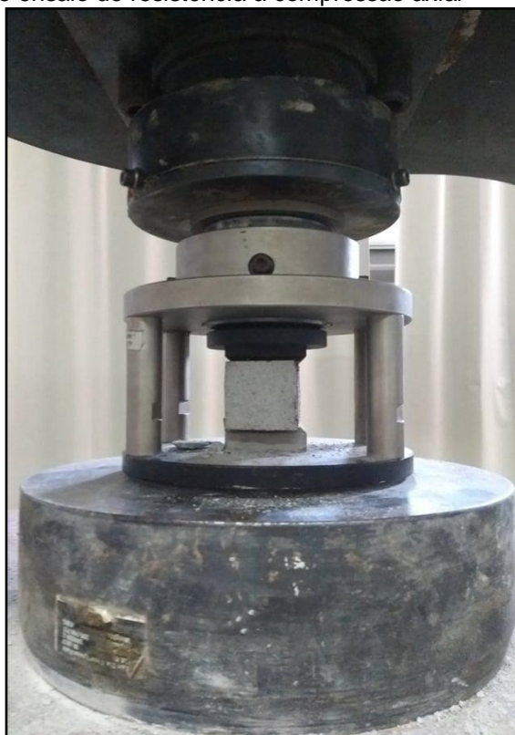
Figura 35 – Equipamento e ensaio de resistência à compressão axial
