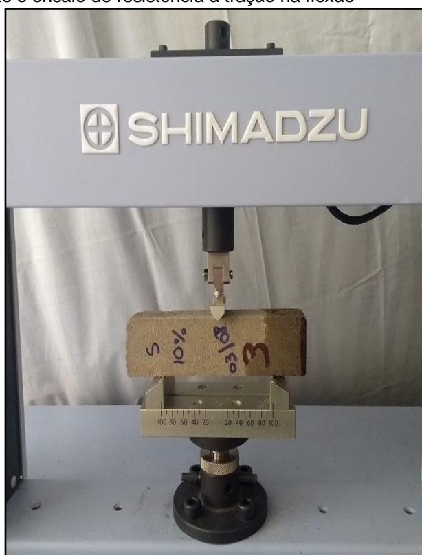
Figura 34 – Equipamento e ensaio de resistência à tração na flexão
