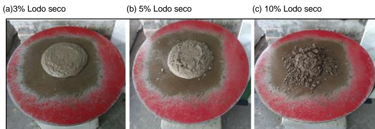
Figura 37 – Demonstração da perda de consistência à que os teores de lodo seco foram aumentando nas argamassas
