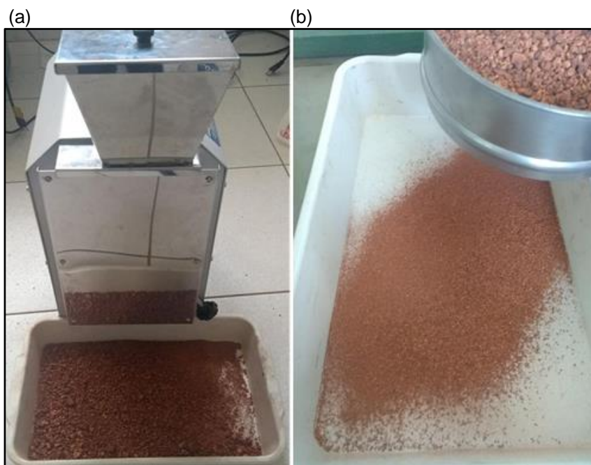
Figura 9 – Moinho de solos (a) e passagem do lodo LC na peneira 0,6 mm (b)
