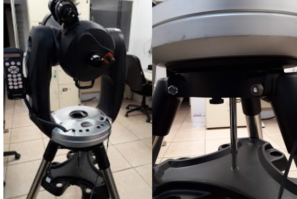
Figura 1: encaixe e fixação do telescópio no tripé.
