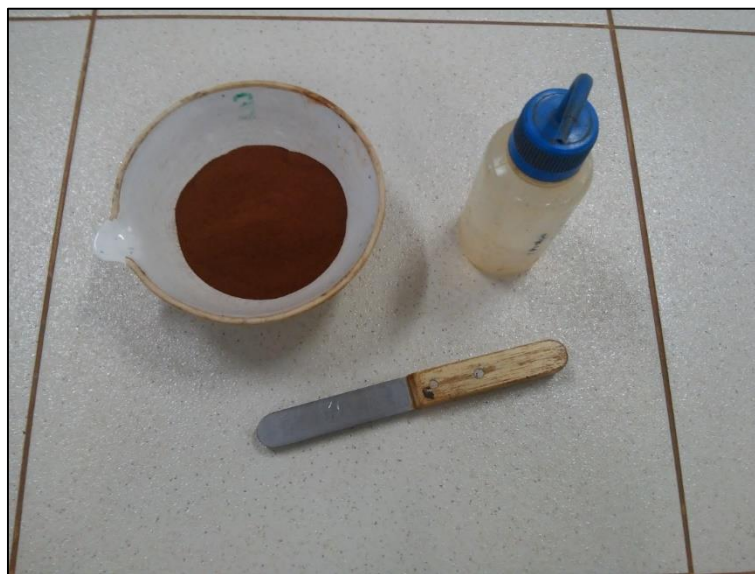
Figura 14 - Materiais empregados na preparação da pasta de solo
