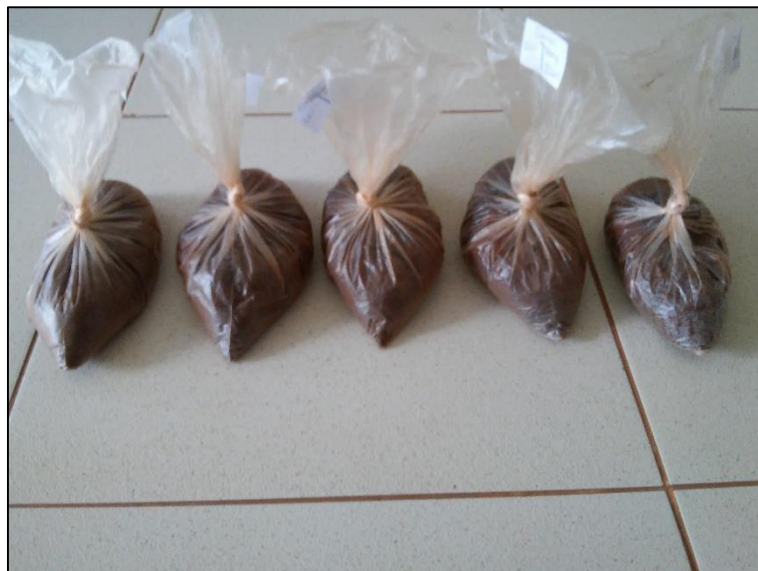
Figura 24 - Porções de solo acondicionadas em sacos de polietileno
