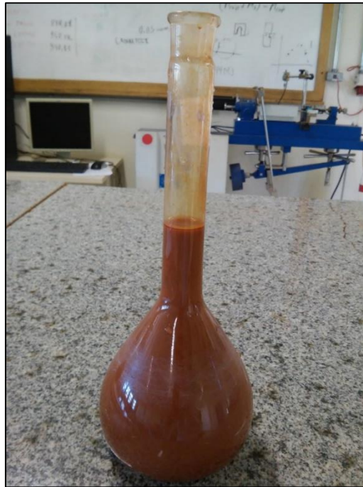
Figura 21 - Picnômetro com conteúdo até a marca de referência
