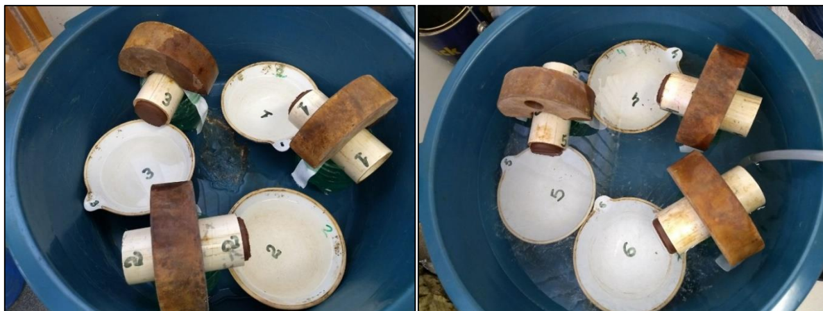
Figura 27 – Introdução de água no recipiente de imersão
