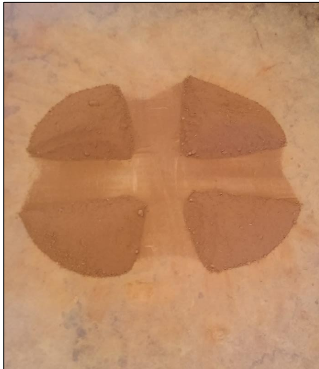
Figura 8 - Processo de quartejamento do solo
