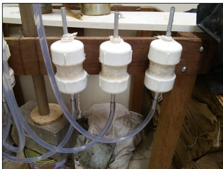
Figura 32 - Permeômetros fixados e com a mangueira de alimentação
