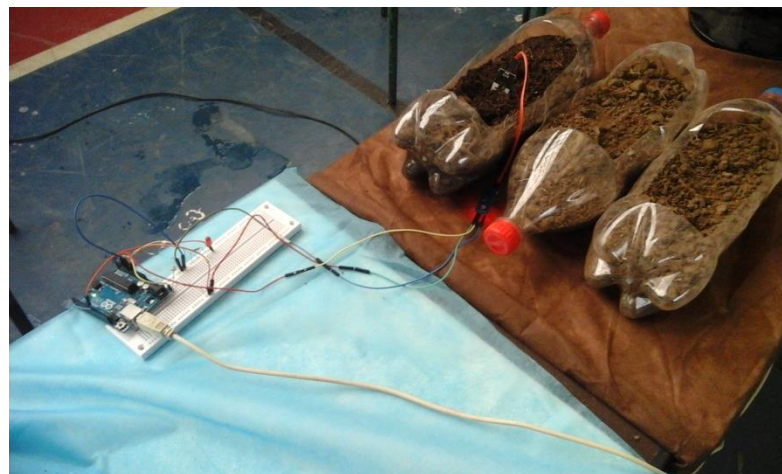
Figura 30 – Garrafas contendo terra para demonstração utilizando sensor de umidade ligado ao Arduino.
