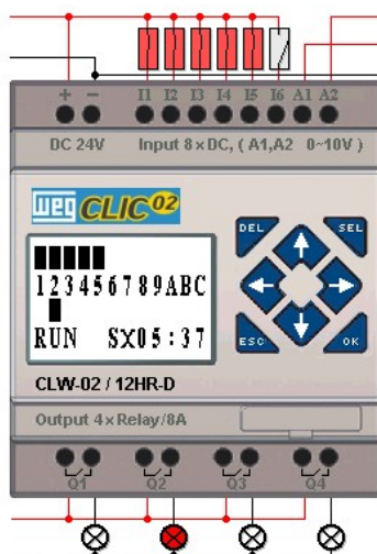
Figura 4033 - Todas as entradas ativadas quando esta alimentando a carga pelo gerador
