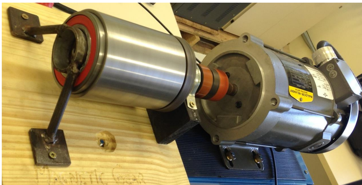
Figura 19 - Engrenagem magnética na bancada de testes.
