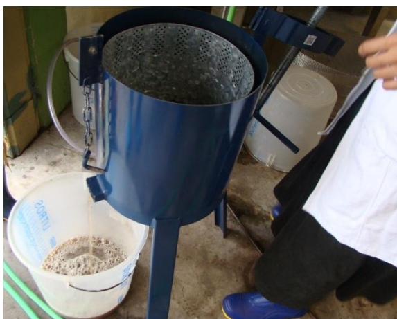
Figura 7 - Utilização da prensa manual, durante o processamento das uvas 'Marselan'
