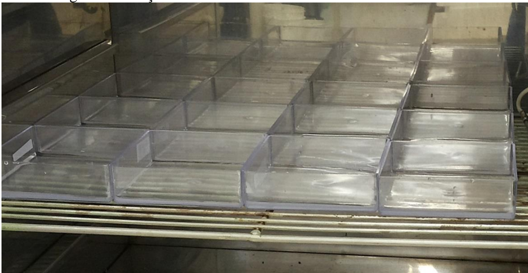
Figura 21 - Secagem da solução formadora dos filmes – técnica de vazamento.
