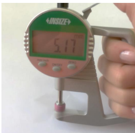
Figura 29 – Medidor de espessura digital.
