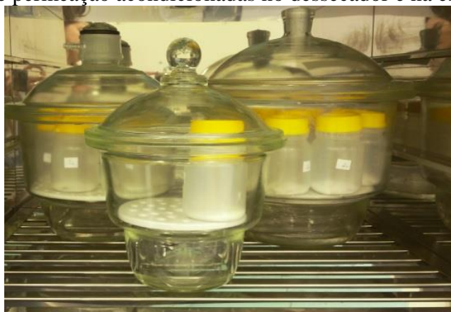
Figura 24 – Células de permeação acondicionadas no dessecador e na estufa.
