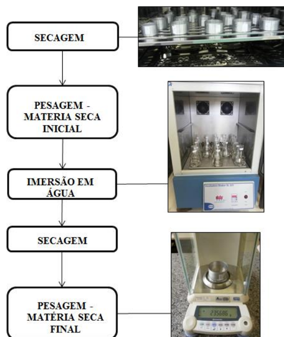
Figura 31 – Fluxograma do método de determinação da solubilidade.
