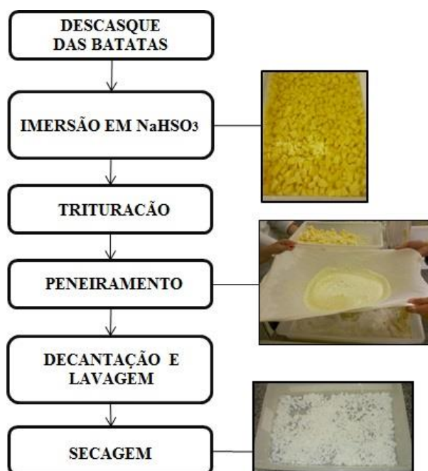
Figura 16 - Fluxograma de extração do amido de batata rosa asterix.
