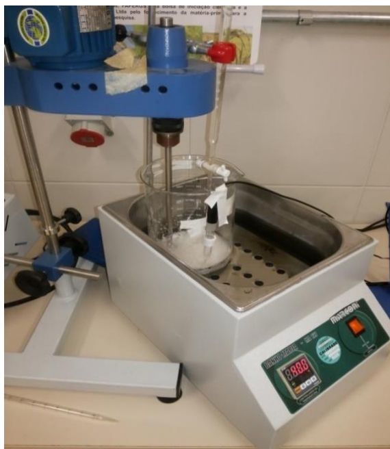
Figura 17 – Reator confeccionado para oxidação do amido de batata.
