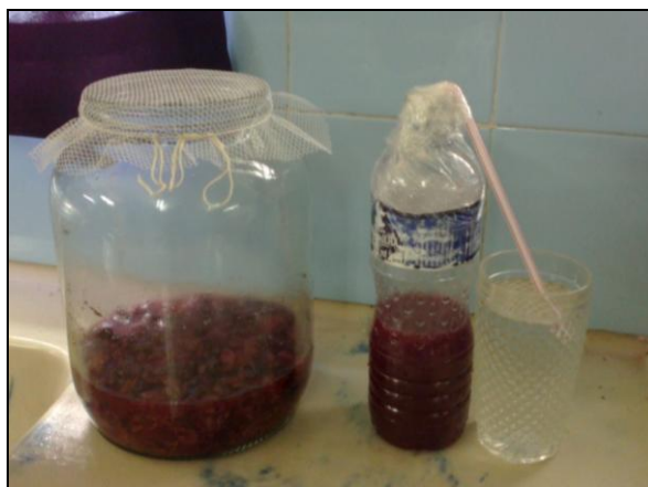
Figura 9: Processo fermentativo após 5 dias, com “batoque hidráulico” improvisado
