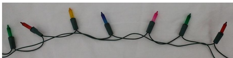
Figura 11 - Lâmpadas natalinas associadas em série
