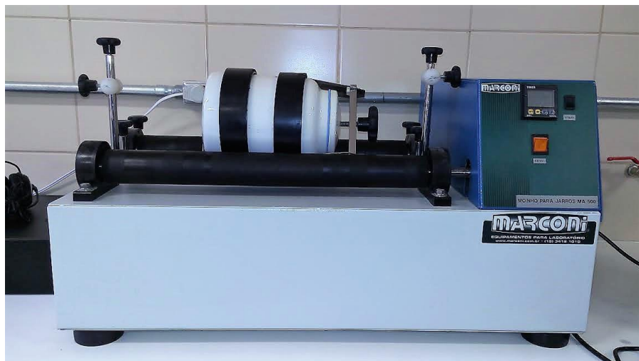
Figura 14 - Equipamento utilizado para etapa de moagem das amostras: moinho de bolas.
