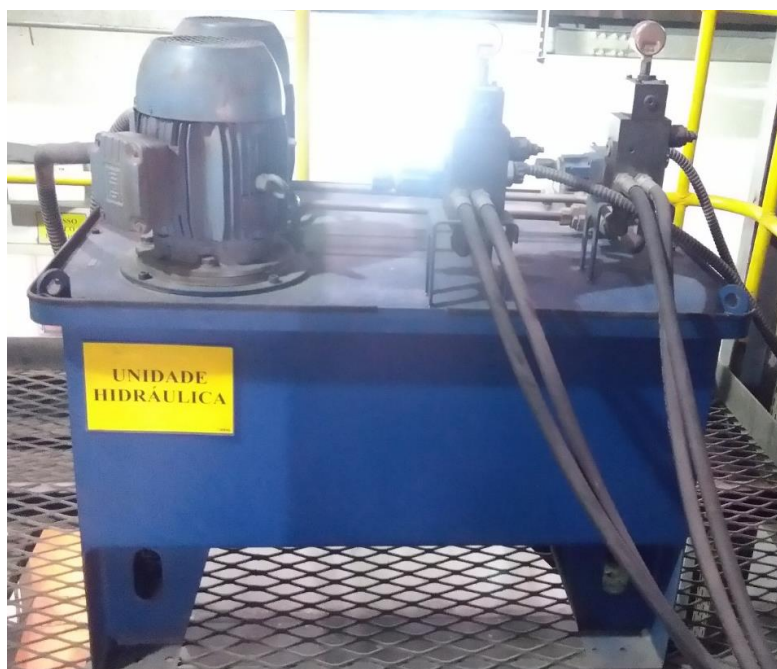
Figura 9 – Unidade Hidráulica de avanço e retorno dos cilindros das grelhas.
