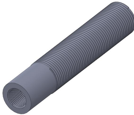
Figura 7 – Elemento de fixação do corpo de prova na extremidade inferior
