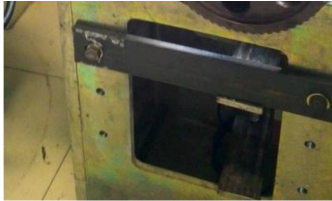
Figura 32 – Instalação das barras laterais
