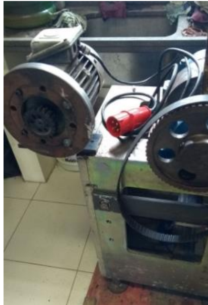
Figura 37 – Instalação do motor à estrutura da máquina
