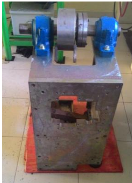
Figura 31 – Conjunto de eixo e mancais instalados na estrutura
