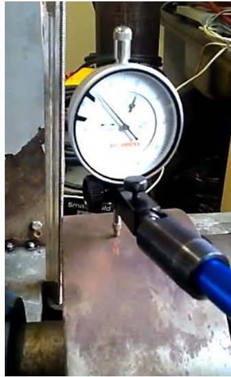
Figura 36 – Averiguação da flecha com relógio comparador
