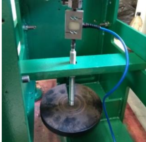
Figura 21 – Calibração célula de carga.
