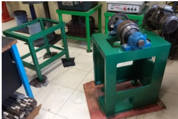
Figura 39 – Estrutura e base após a primeira demão de tinta de acabamento
