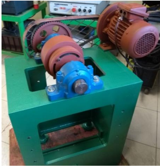
Figura 40 – Segunda demão e pintura dos demais componentes
