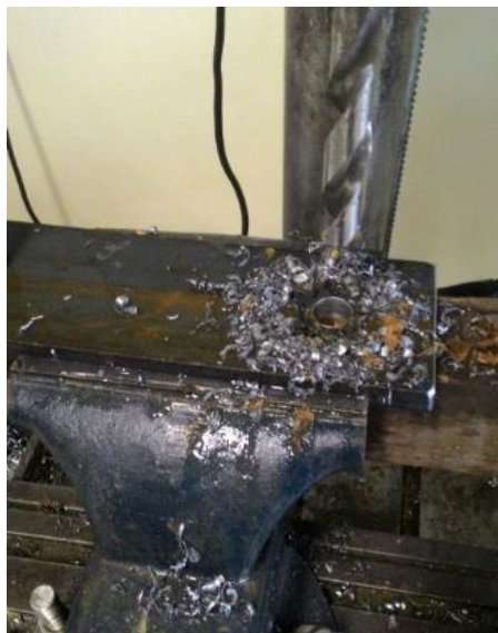
Figura 25 – Processo de furação da barra lateral
