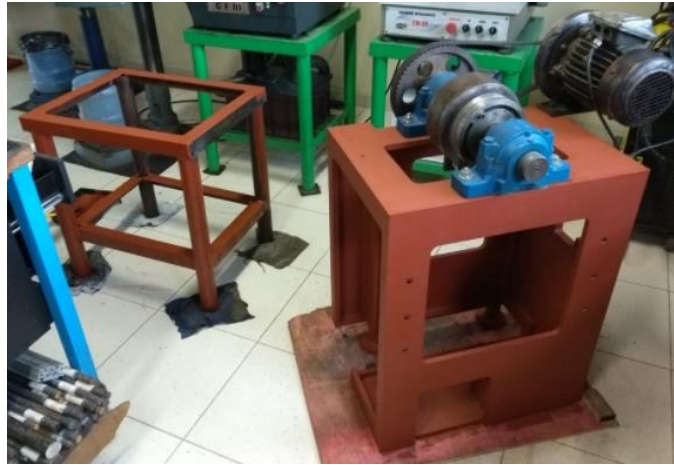
Figura 38 – Componentes recebendo a base de primer vermelho
