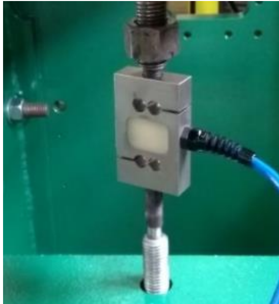
Figura 43 – Célula carga utilizada no teste
