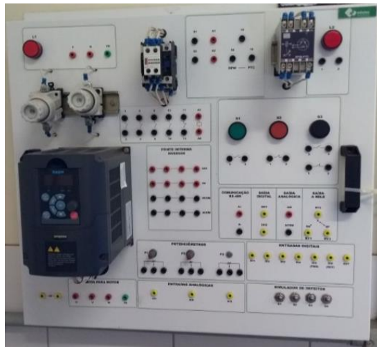
Figura 20 – Painel contendo o inversor de frequência
