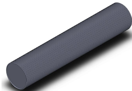
Figura 8 – Elemento de fixação do corpo de prova na extremidade inferior
