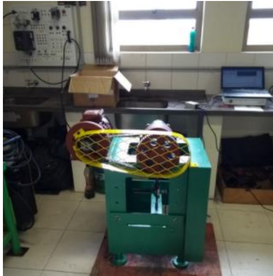
Figura 44 – Máquina com controlador e Data-logger instalados
