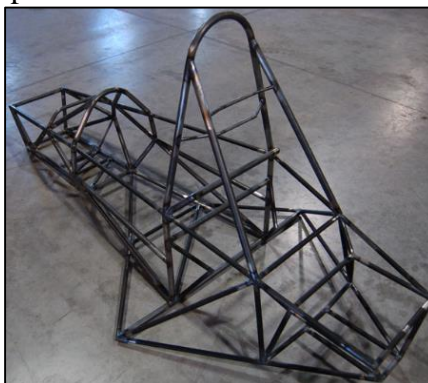
Figura 3 - Chassi baja do tipo Space Frame.
