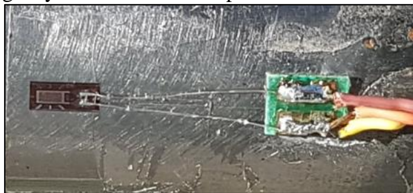
Figura 27 - Strain gage Kyowa de 120 \Omega do tipo folha.
