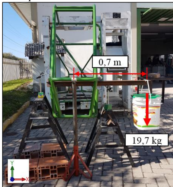
Figura 31 - Aplicação do torque na dianteira do chassi.
