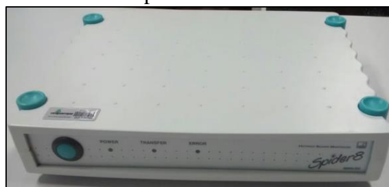
Figura 28 - Condicionador de sinais Spider 8.
