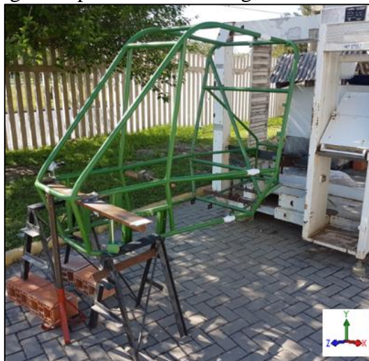
Figura 29 - Chassi configurado para o ensaio de rigidez torcional.
