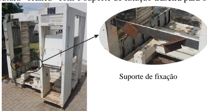
Figura 22 - Estrutura “branca” com o suporte de fixação traseira para o baja.
