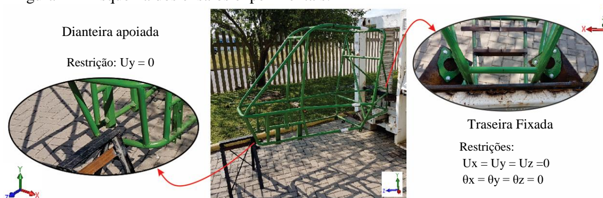
Figura 21 - Esquema dos ensaios experimentais.
