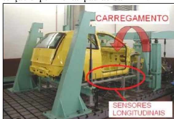
Figura 18 - Ensaio de torção experimental padrão da FIAT.
