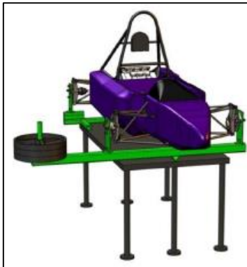
Figura 16 - Esquema do teste de rigidez torcional utilizando um pivô central.
