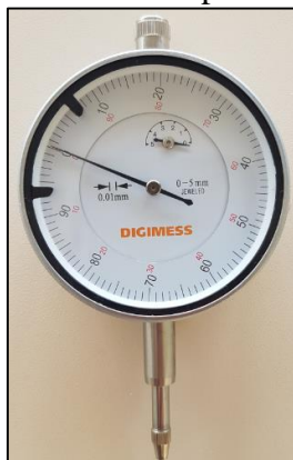
Figura 26 - Relógio comparador utilizado no experimento de rigidez torcional.
