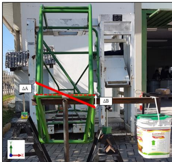
Figura 43 - Deslocamentos dianteiros do chassi em decorrência do torque.
