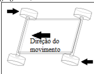
Figura 9 - Deformação lozengeing horizontal .
