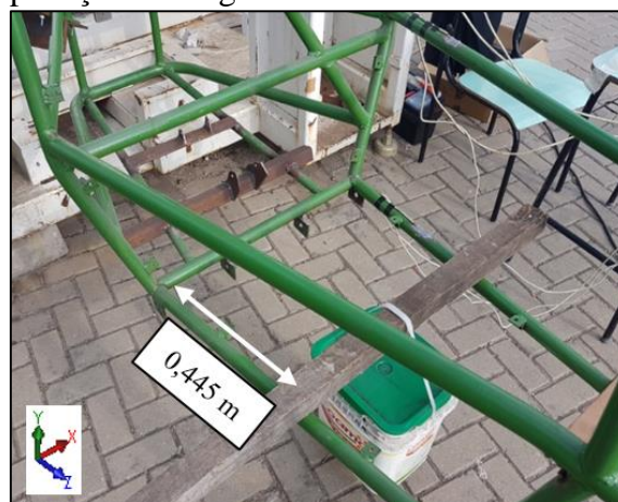
Figura 33 - Local de aplicação da carga estática.
