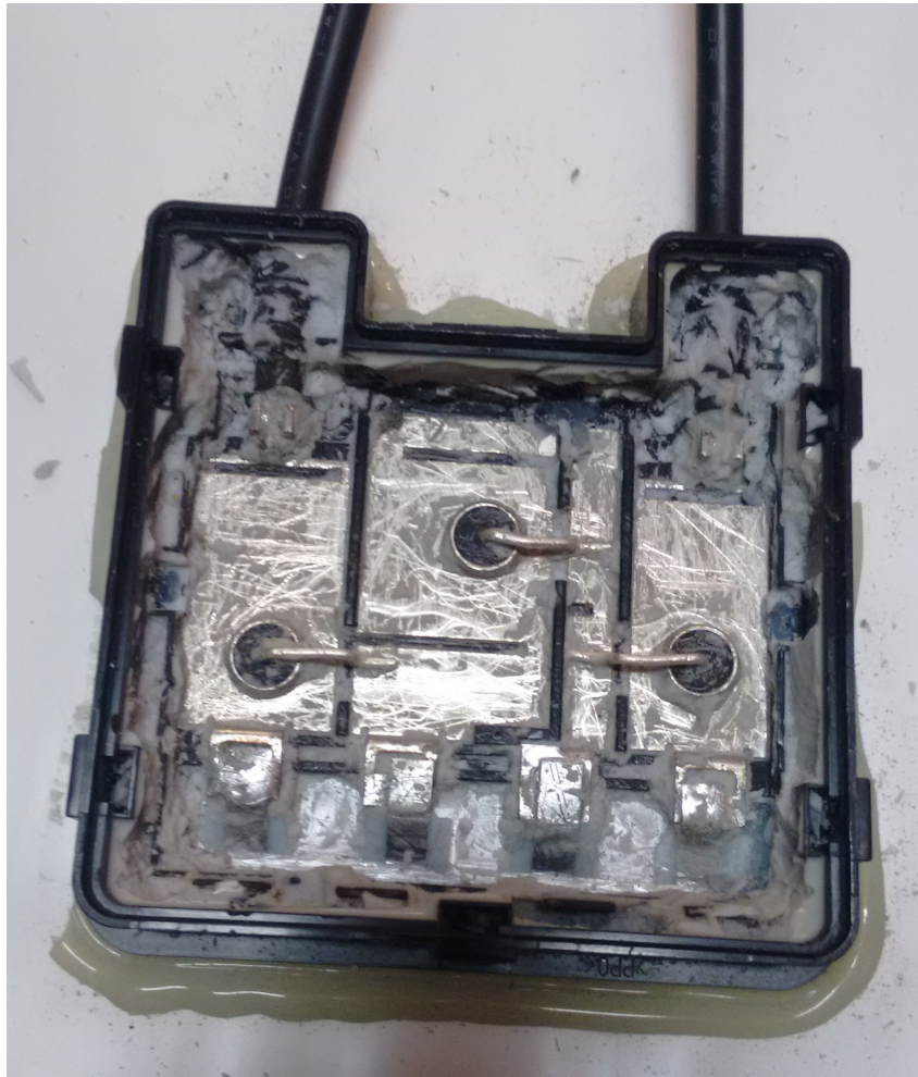
Figura 16 – J-box do painel fotovoltaico sem a presença de diodo de bypass .
