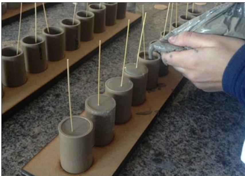
Figura 35 - Lançamento da mistura nos tubos de PVC
