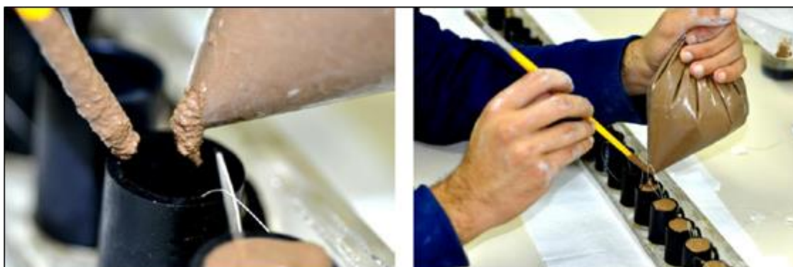
Figura 20 - Moldagem dos corpos de prova para ensaio de arrancamento
