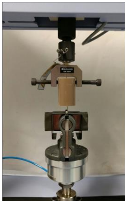
Figura 39 - Configuração do ensaio de arrancamento (a) e detalhamento (b)
