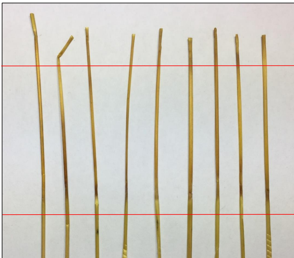
Figura 47 - Fibras removidas dos corpos de prova com embebimento de 50 mm
