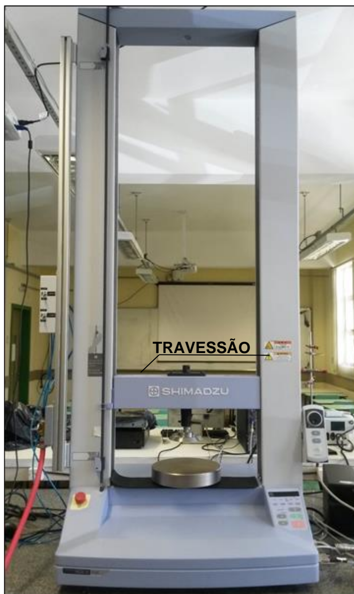
Figura 27 - Máquina de ensaios mecânicos utilizada para os ensaios de tração direta das fibras e para ensaio de arrancamento
