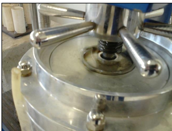
Figura 12 – Equipamento de Confinamento da Amostra para Ensaio.
