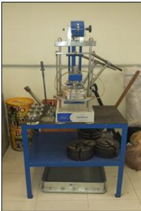
Figura 11 – Equipamento de Ensaio de Adensamento Unidimensional
