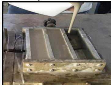
(b) Moldagem dos corpos de prova
