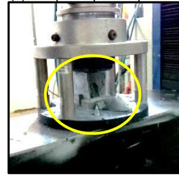
(d) Corpo de prova após ensaio de compressão
