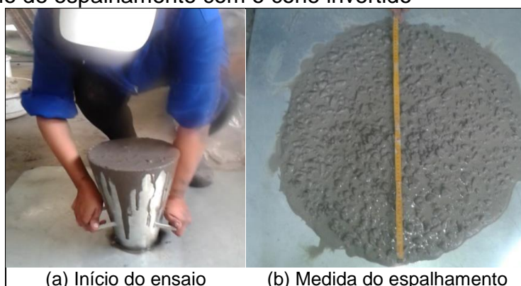
Figura 8 – Ensaio de espalhamento com o cone invertido
