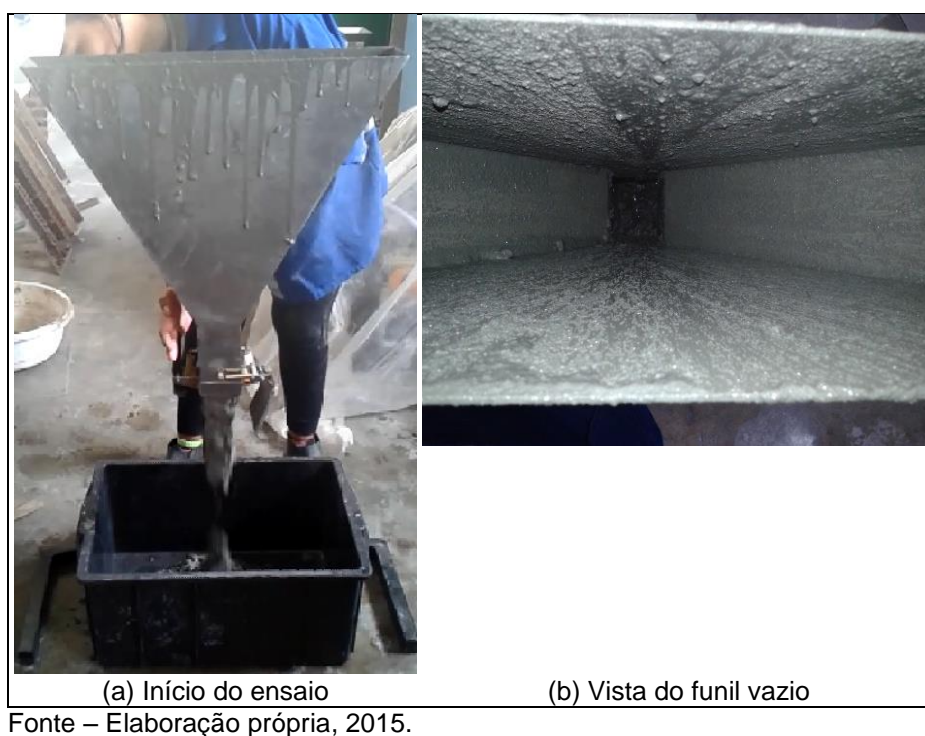
Figura 9 – Ensaio com o Funil-V
