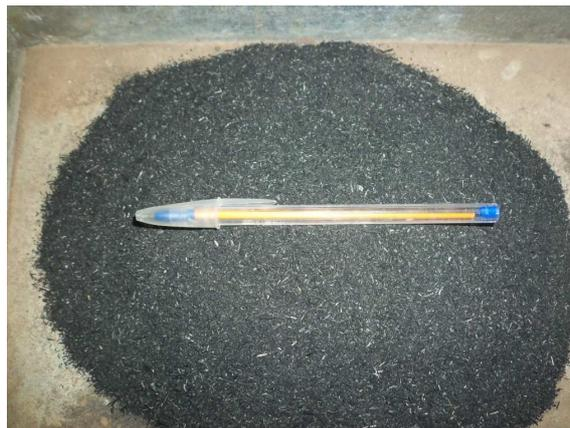
Figura 7 - Cinza de Casca de Arroz obtida do processo de queima sem controle
