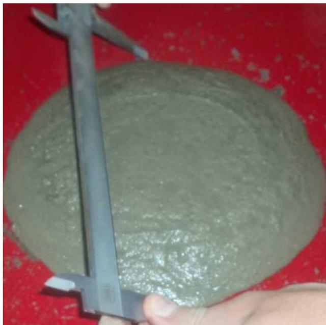
Figura 10 - Ensaio de Consistência de Argamassa
