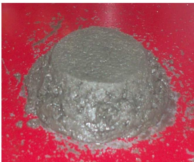
Figura 12 - Argamassa com 10% CCQ depois da retirada do molde tronco-cônico
