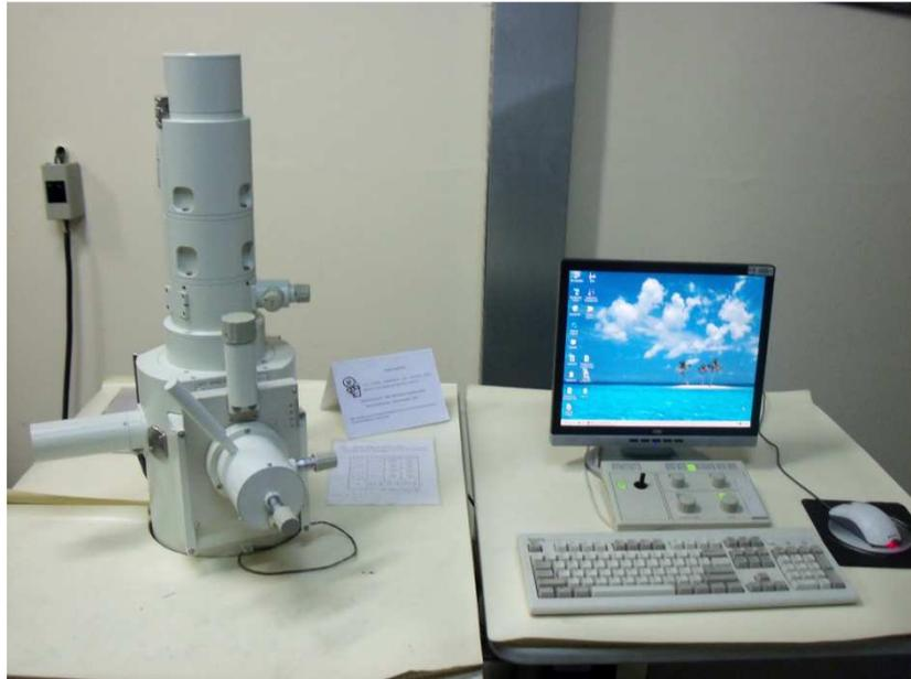
Figura 17 – Microscópio Eletrônico de Varredura (MEV)
