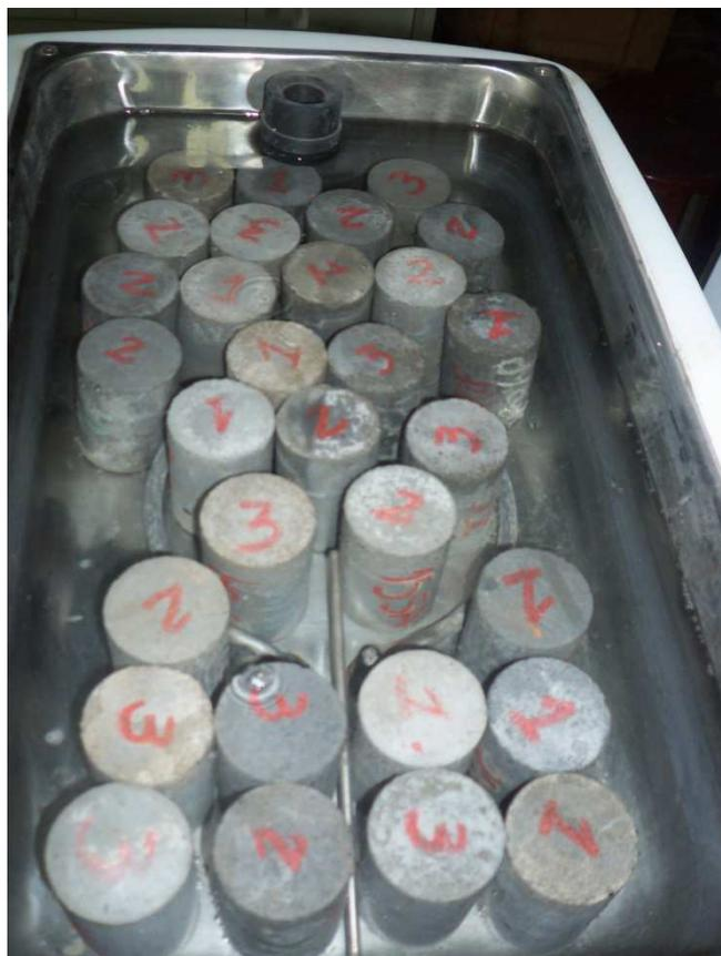
Figura 20 - Ensaio de absorção por imersão
