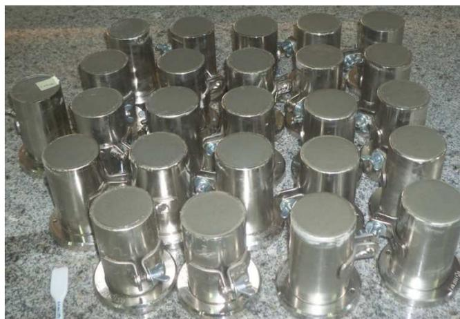
Figura 14 - Corpos de Prova Cilíndricos Moldados.
