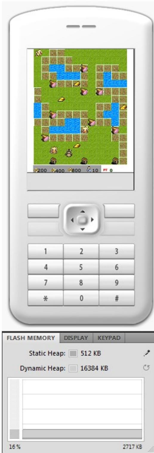
**Ilustração 54:** Execução do algoritmo A\* 24x29 tiles - pico de uso de memória durante a execução
