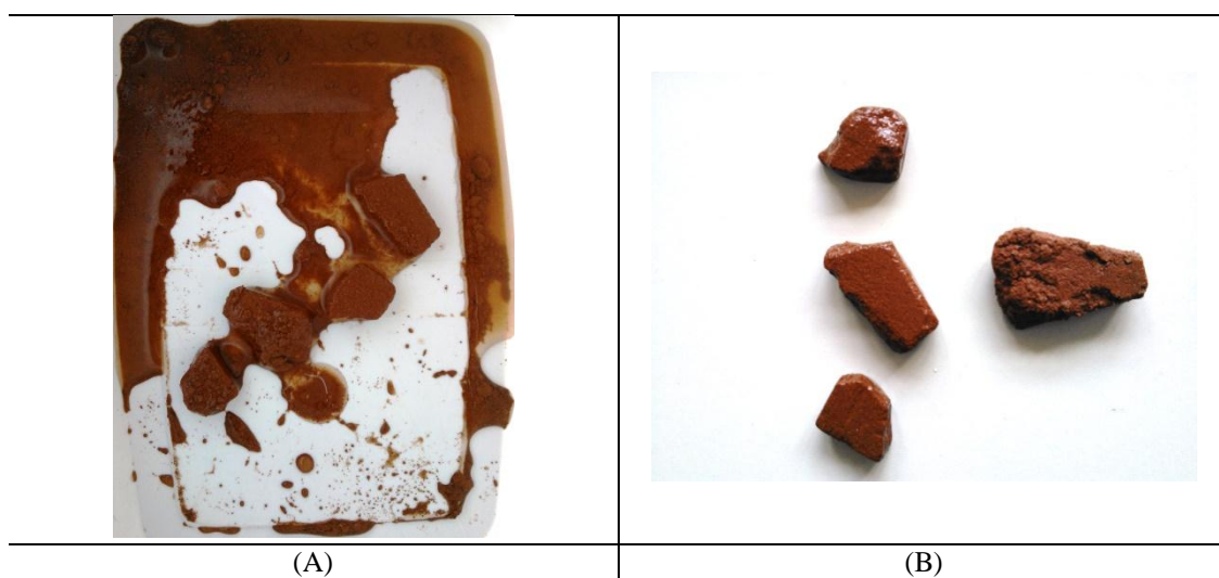
Figura 44 - Produtos cerâmicos prensados (A e B) desmanchados após o ensaio de PA.
