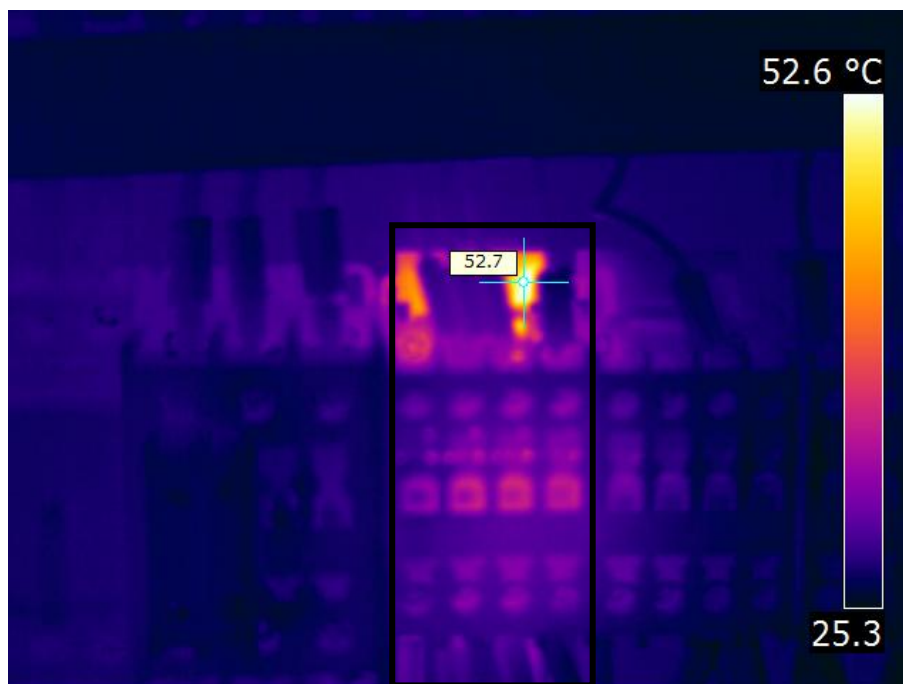
Figura 49-Imagem térmica da contatora do PSC-016
