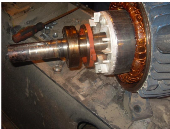
Figura 43- Rolamentos que serão trocados pelos novos.
