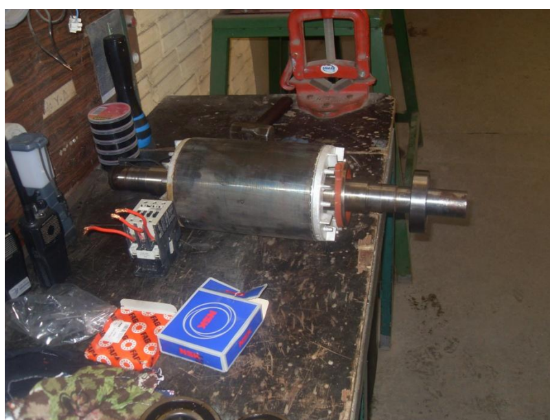
Figura 45-Rolamento novo colocado no eixo.
