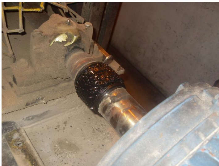
Figura 42-Eixo antes da limpeza e lubrificação.
