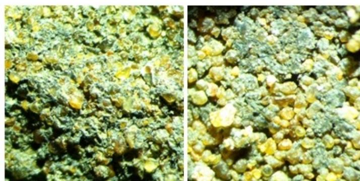
(b) Superfície de fratura dos tijolos sem fibra
