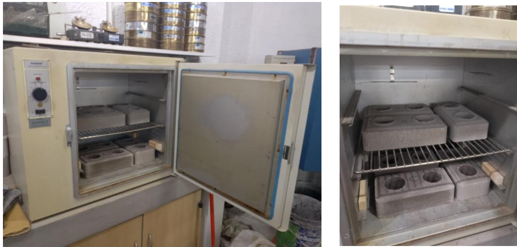
Figura 7 – Secagem dos corpos de prova para ensaio de absorção de água
