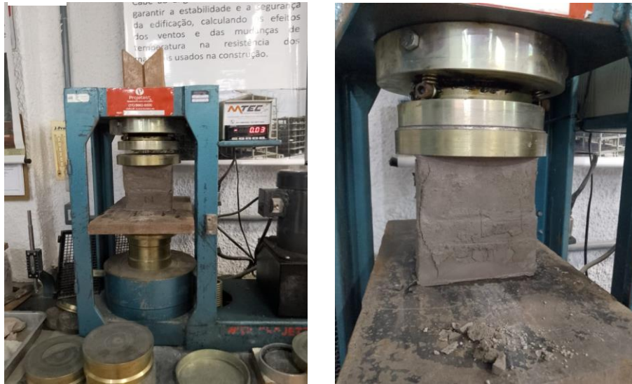
Figura 6 – Compressão dos tijolos (a) prensa utilizada (b) tijolo na prensa e após rompimento
