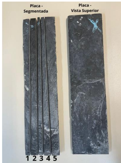
Figura 21 – Placa segmentada na seção vertical da moldagem e corpo de prova sem sofrer alterações
