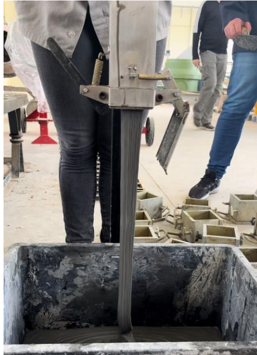
Figura 24 – Imagem obtida durante a da execução do ensaio no Funil V
