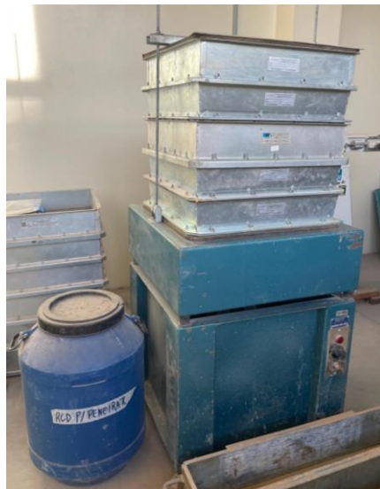
Figura 12 – Peneirador mecânico utilizado para obter as frações de AN e RCD utilizadas
