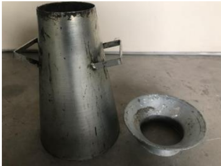
Figura 14 – Cone de Abrams
