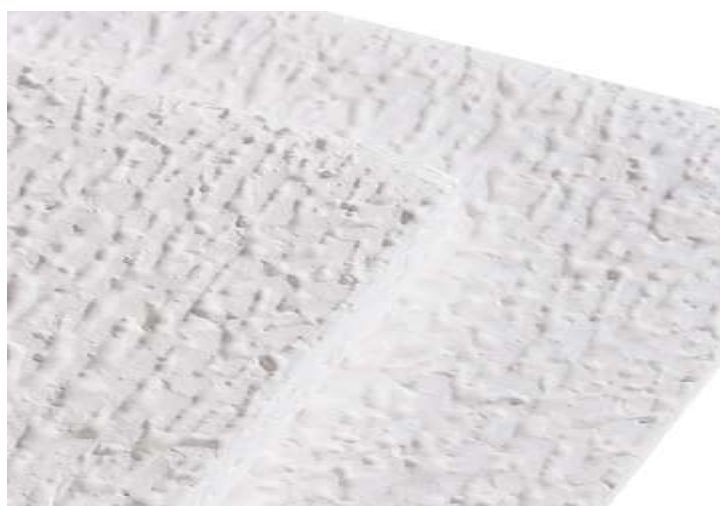
Figura 10 - Placa de EPS 1F para isolamento térmico
