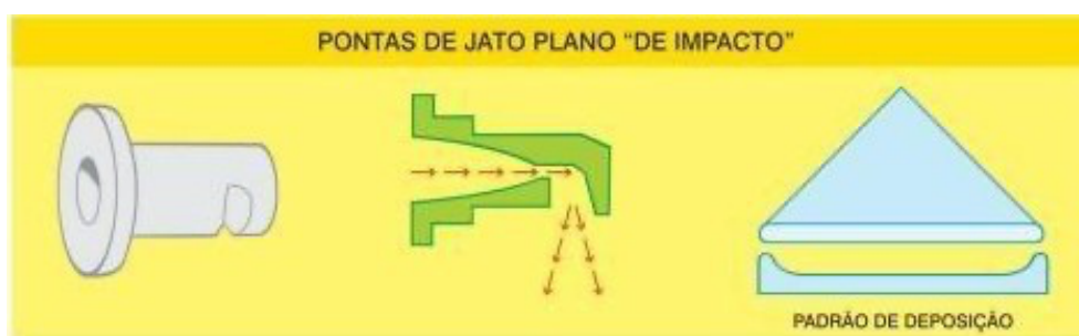
Figura 4 – Esquema de funcionamento da ponta de impacto
