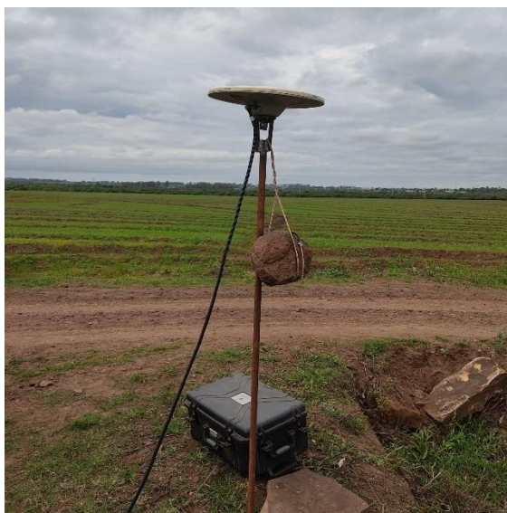
Figura 7 – Equipamento para correção de posicionamento pós processada (PPK).
