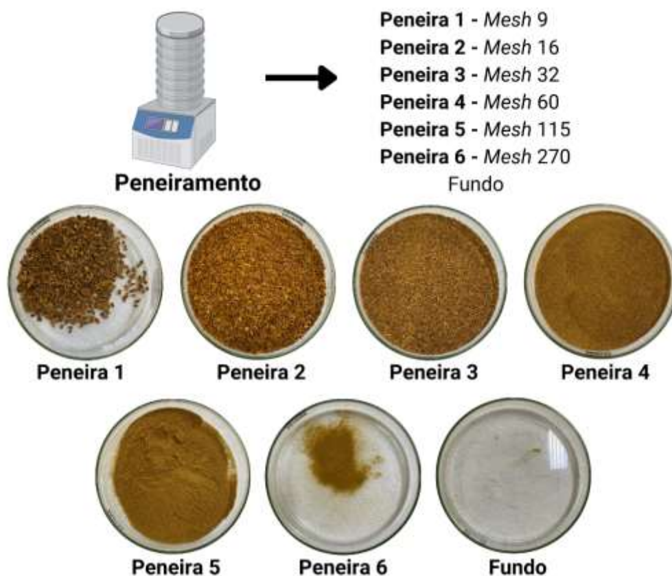
Figura 10 - Quantidade de amostra retida em cada peneira
